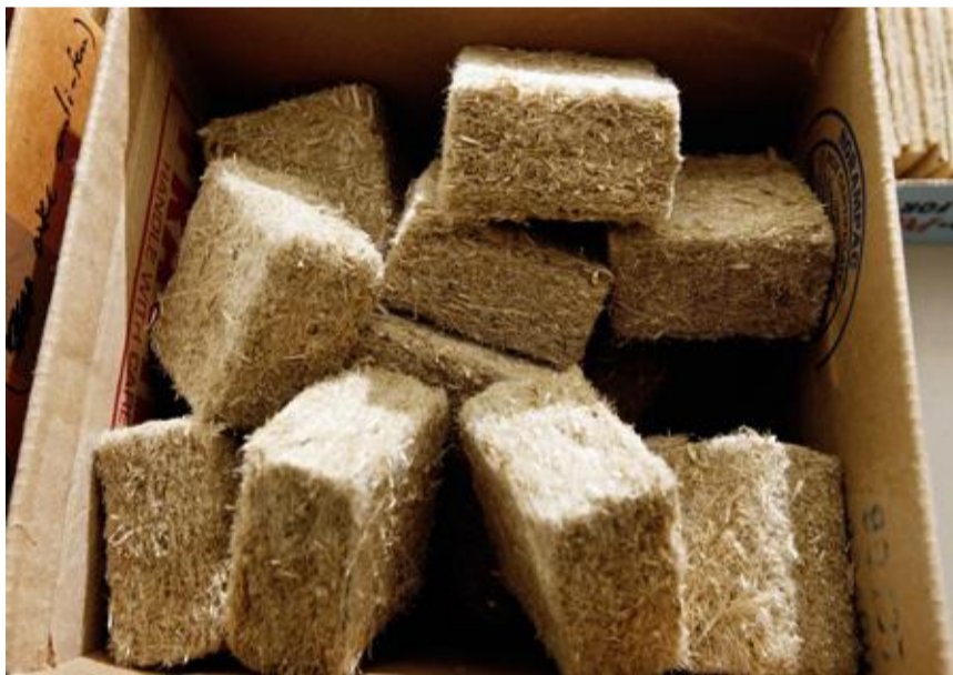
Du point de vue thermique et phonique, les fibres végétales d'herbe sont aussi performantes que les isolants conventionnels. Photos Olivier Born
